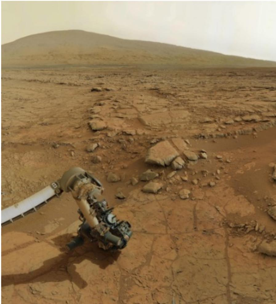
**Figura 5:** *El brazo del robot Curiosity tomando una muestra de tierra marciana.* Fotografía: NASA / JPL-Caltech / Olivier de Goursac.
