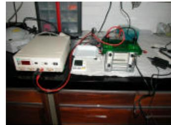
Estas figuras muestran el aparato para electroforesis utilizado en la experiencia.
